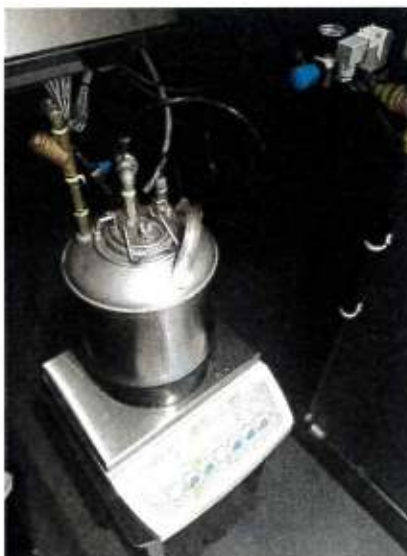
Serbatoio contenente l'acqua per il test
